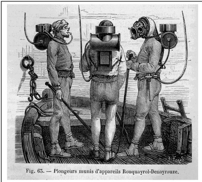
**Denayrouze** qui fabriquèrent en 1862 le premier détendeur-régulateur permettant d'alimenter en air un plongeur équipé d'un masque et d'un embout buccal
